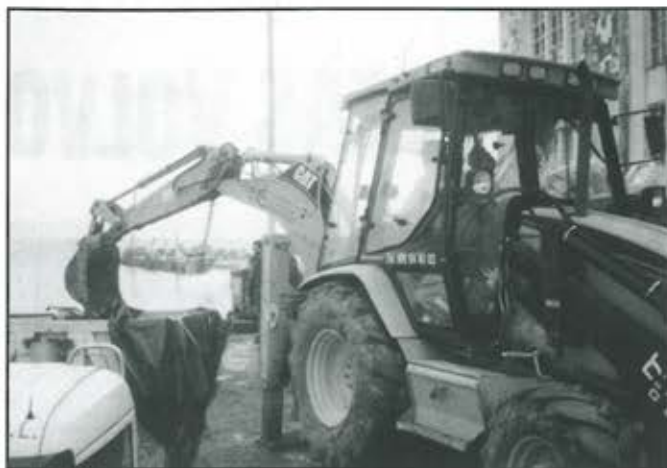
La mixta utiliza su cazo para aplastar las bolsas contenidas en los camiones.
